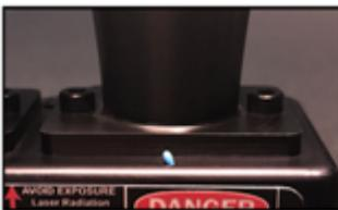
La diode bleue indiquée dans la photo, sous les jumelles est un thermomètre. Le Focus Bug ajuste son fonctionnement en fonction de la température.
