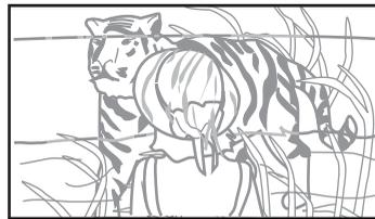
Une image superposant un signal A et un signal B est affichée. Le rapport de mixage de deux signaux d'entrée se modifie à l'aide du bouton rotatif PHASE du contrôleur.
