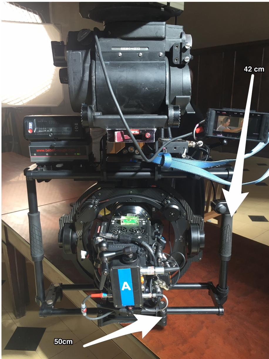
L'amplitude des panneaux est donc limitée. Environ 160° droite / gauche, haut / bas. Liberté réduite sur un JIB par exemple. Une caméra compacte, centrée dans le MAXIMA, permettra plus de liberté de mouvement au cadre.
