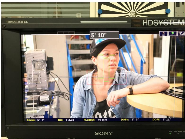
Lorsque les rectangles verts sont partagés de manière équitable entre le haut et le bas, alors la mise au point est optimum. Si les rectangles apparaissent blancs au dessus, alors le lointain est hors profondeur de champs. Si les rectangles apparaissent blancs en dessous, alors l'avant est hors profondeur de champs. Ceux qui le
