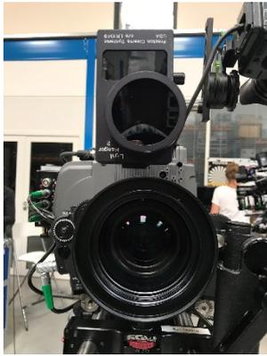
Le LR2 se compose du boîtier de mesure (photo 1) que l'on fixe sur la caméra
