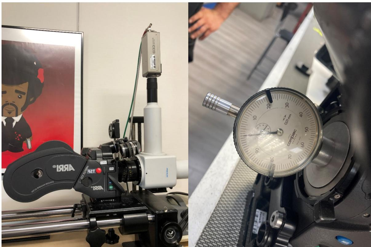
Figure 2 - Un collimateur (à gauche) et un comparateur ou « palmer » (à droite)
