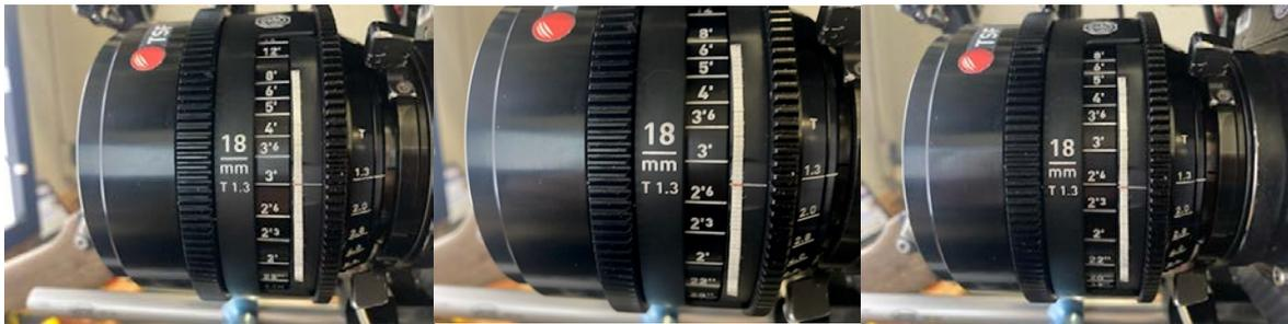
Figure 12 - Feuille de papier millimétré collée sur une optique. De gauche à droite : optique à 0 (marque à 3'), à -5 rapport 1, et à -5 rapport 2 (donc -10)
