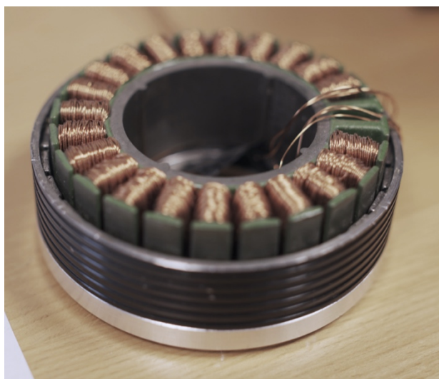
Photo d'un des moteurs électromagnétiques du StabOne
