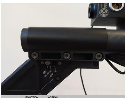
Sur le STAB lui-même il y un bouton à 3 positions OFF / REMOTE / JOYSTICK.
