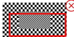
Installer la caméra perpendiculairement à la mire, en veillant à ce que la caméra reste centrée quelque-soit la distance. *Astuce : vous pouvez demander une dolly avec une tête manivelle type ARRIHEAD pour vous faciliter la vie sur les étapes suivantes. Des rails callés perpendiculairement peuvent aussi être très utiles. Cependant, l'installation est chronophage et les Lens Grid peuvent très bien être fait avec tête et branches classiques*
