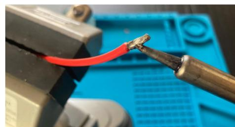
**Attention :** (Pour des raisons de praticité de prise de vue) sur la photo d'illustration ci-dessus, **l'étain n'est pas en contact avec le fil dénudé, il doit absolument l'être pour réaliser correctement le pré-étamage : l'étain sur le fer seul n'est pas suffisant pour réaliser cette opération.**
