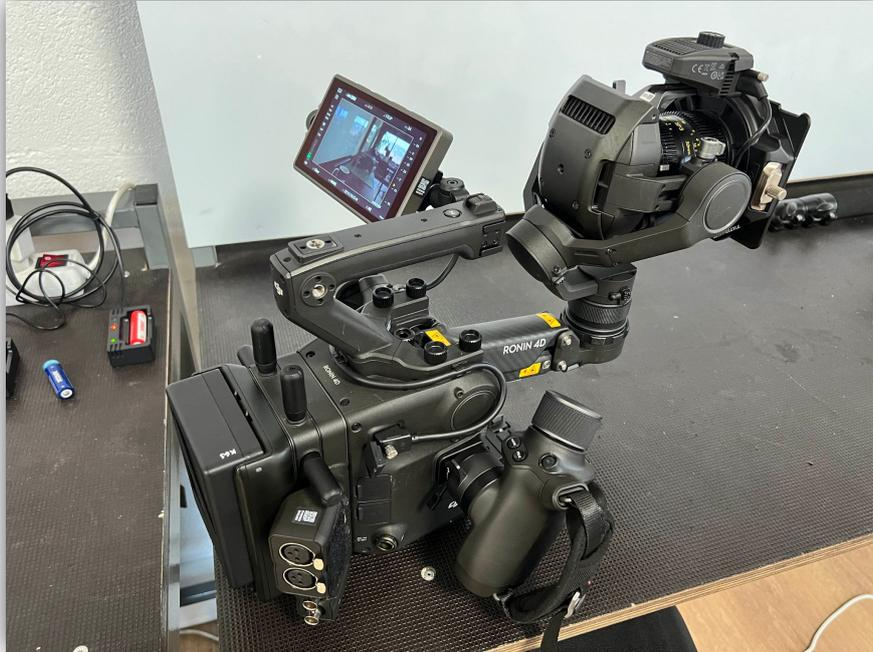
La principale différence avec les autres têtes stabilisées réside dans le **4e axe** qui permet de compenser le "walking effect". Il s'agit d'un grand bras qui va sortir la nacelle du corps caméra et compenser les variations de hauteur à chaque pas. Les capteurs pour ce 4e axe sont situés devant et sous la nacelle, il faut donc faire attention à ne pas obstruer cette zone.
