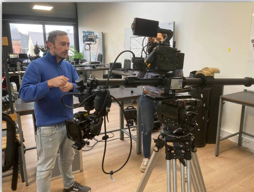
*Ronin 4D avec flex (câble), sur système Flexpro (bras télescopique)*
